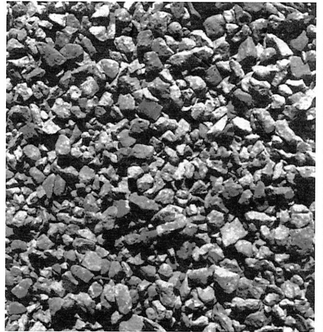
Figure 28 Granulat en béton recyclé (CPCA)
